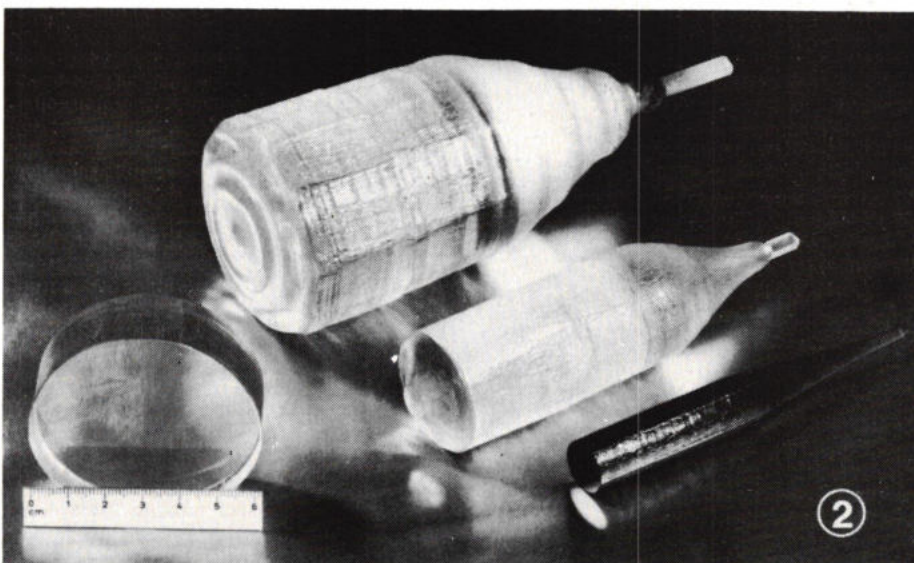
Afb. 2. Reuzenkristallen van gadolinium-gallium-granaat gekweekt volgens een geautomatiseerde Czochralski-techniek.
